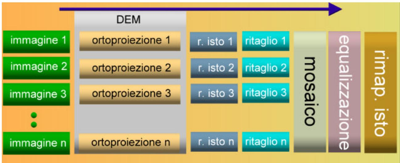
Figura 3 - Pipeline per la generazione di un ortomosaico
